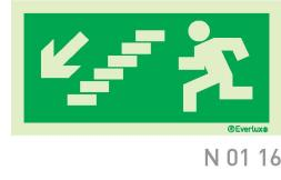
For å skifte ut, legge til eller komplettere eksisterende ledesystemer for rømning i byggverk, brukes etterlysende sikkerhetsskilt i henhold til standarden som brukes i det eksisterende systemet
