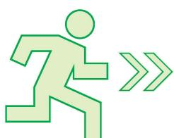
Til hvert av de ekstra store skiltene anbefales bruk av piler som står i forhold til størrelsen på skiltene. Hvis skiltet har en diameter på 300mm, bør det monteres piler med bredde på 83mm.
