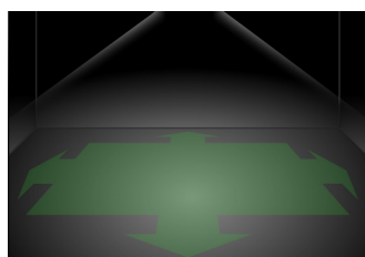
Belysning av fluktvei / åpent område med symmetrisk linse
